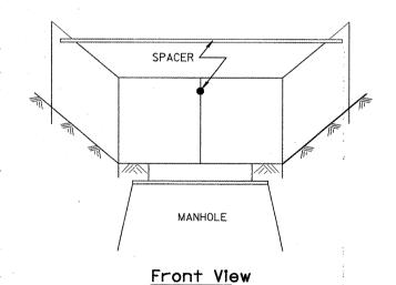
EROSION CONTROL AT OPEN GRATE MAN HOLE
