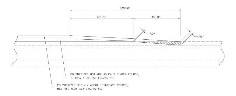
HOT-MIX ASPHALT SURFACE REMOVAL - BUTT JOINT AT MAINLINE PAVEMENT TRAVELED WAY
