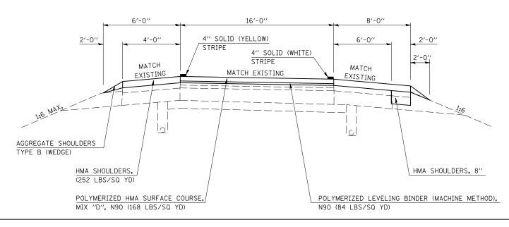
TYPICAL NOTE:EARTH EXCAVATION FOR HMA SHOULDERS, 8" SHALL NOT BE MEASURED FOR PAYMENT. THE EXISTING EARTH SHOULDER SHALL BE REMOVED TO THE FACE ALONG THE EDGE OF THE EXISTING SHOULDER. THE MATERIAL REMOVED SHALL EITHER BECOME THE PROPERTY OF THE CONTRACTOR OR DISPOSED OF OUTSIDE THE LIMITS OF THE RIGHT-OF-WAY.
