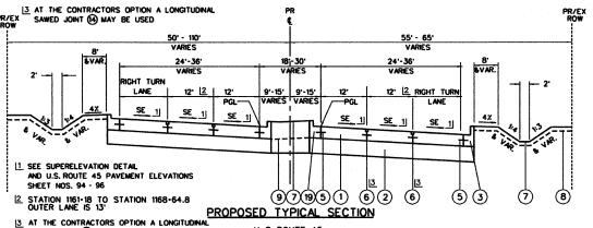
U. S. ROUTE 45 SUPERELEVATION DETAIL
