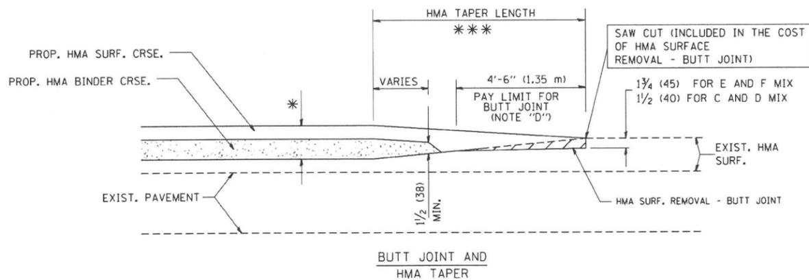
TYPICAL BUTT JOINT AND HMA TAPER
