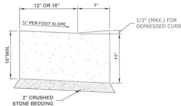
**CURB AND GUTTER AT A.D.A. RAMPS**
