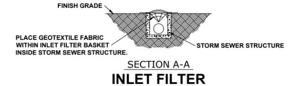
**EROSION AND SEDIMENT CONTROL PLAN**
