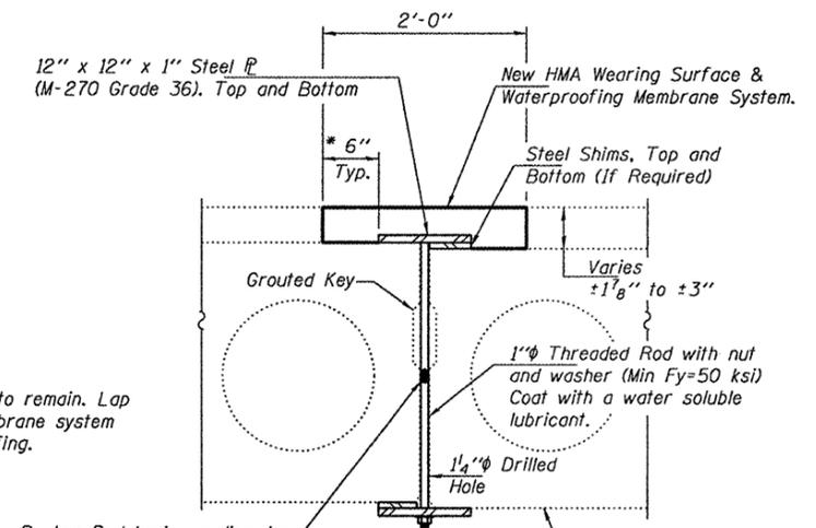
**SHEAR KEY CLAMPING DEVICE**
