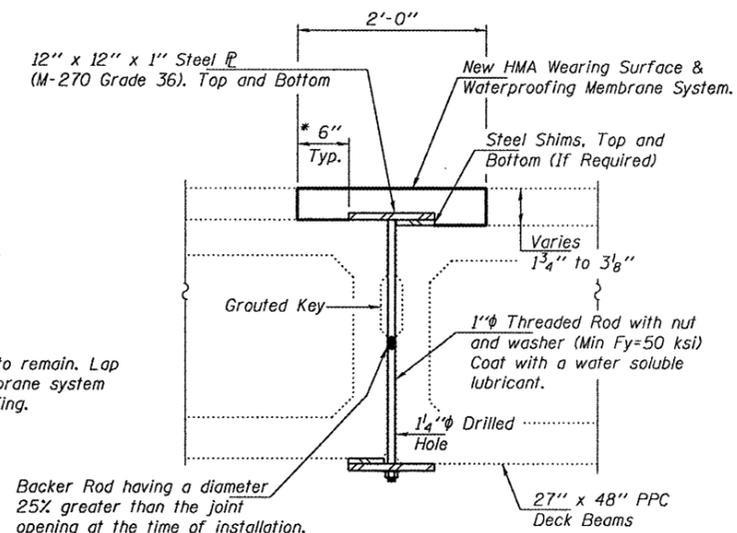
**SHEAR KEY CLAMPING DEVICE**
