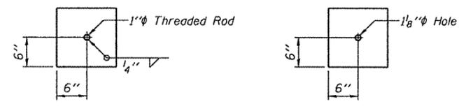
**TOP CLAMPING I.P.**      **BOTTOM CLAMPING I.P.**
