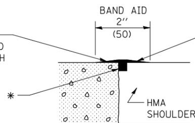
**ANY WIDE LONGITUDINAL JOINT OR CRACK**
