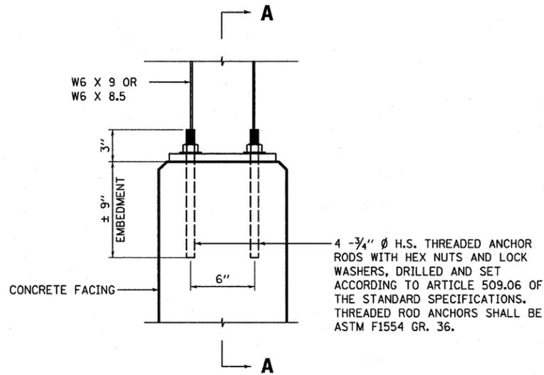
**SECTION AT GUARDRAIL POST**
