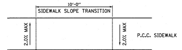
**SIDEWALK SLOPE TRANSITION DETAIL**
