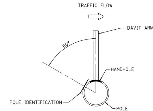
**POLE ON BARRIER WALL OR PARAPET**
