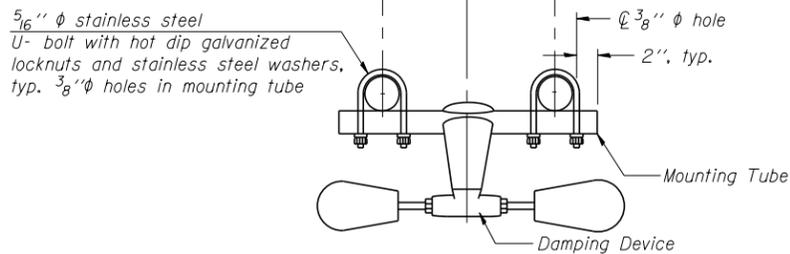
**TRUSS DAMPING DEVICE CONNECTION DETAIL**
