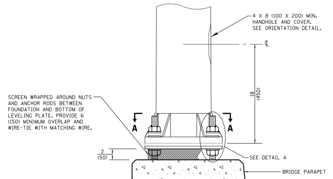
**ELEVATION AT BRIDGE PARAPET**
