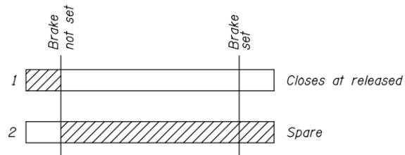
**BRAKE HAND-RELEASED LIMIT SWITCH**
