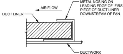
**DUCT LINER RETAINER**
