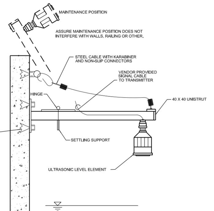
**ULTRASONIC LEVEL SENSOR SIDEWALL HINGE MOUNT N294**
