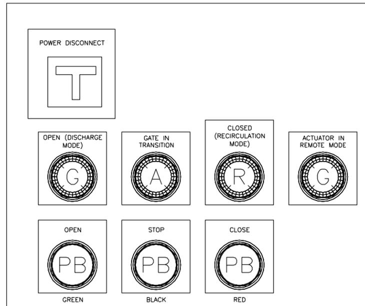
DISCHARGE GATE ACTUATOR - DG-1
