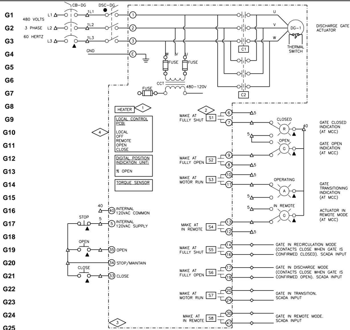
**DISCHARGE GATE ACTUATOR - DG-1**
