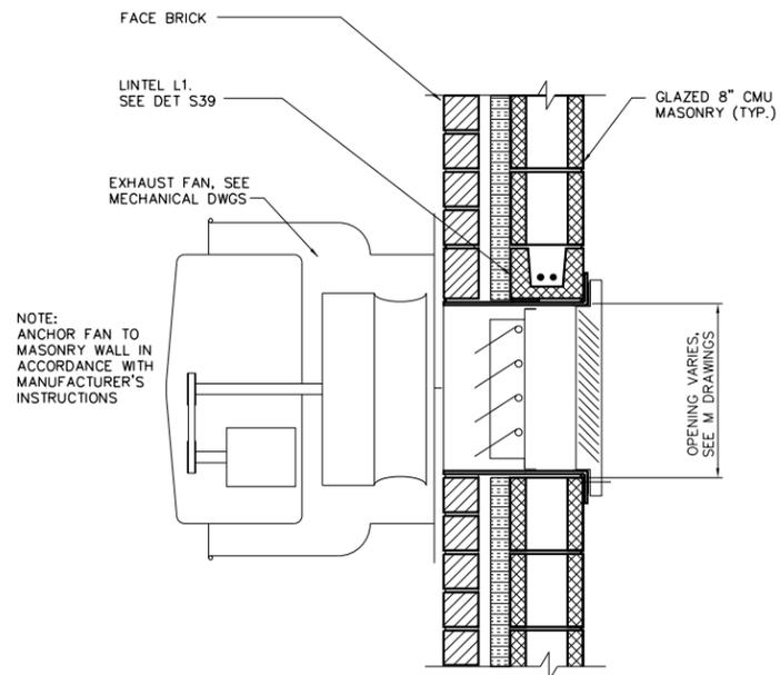
**TYPICAL FAN WALL PENETRATION DETAIL-S32**
