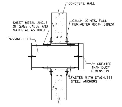
**TYPICAL DUCT WALL PENETRATION DETAIL**
