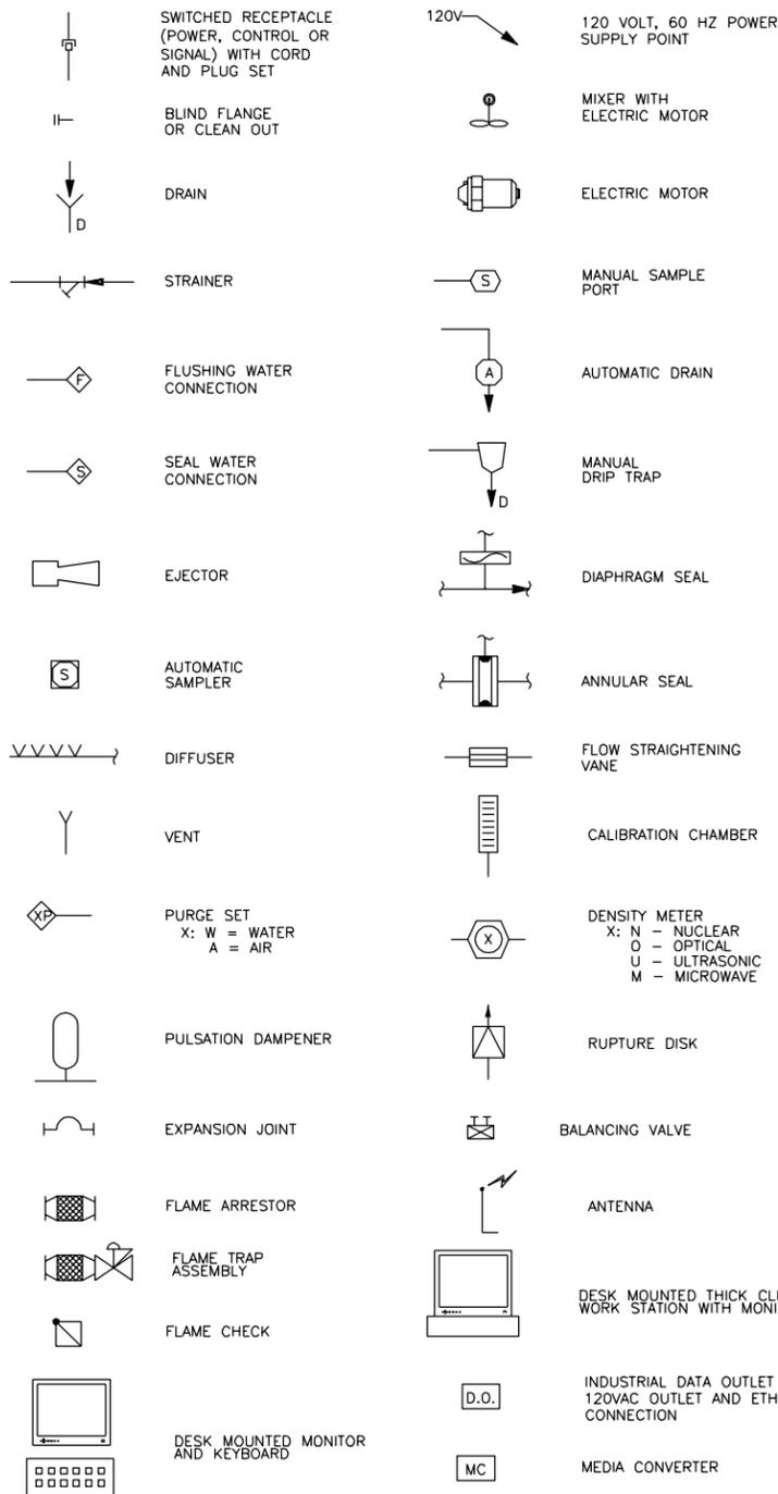
**INPUTS & OUTPUTS (I/O) TO PLC, DAQ OR DISTRIBUTED CONTROL SYSTEMS**
