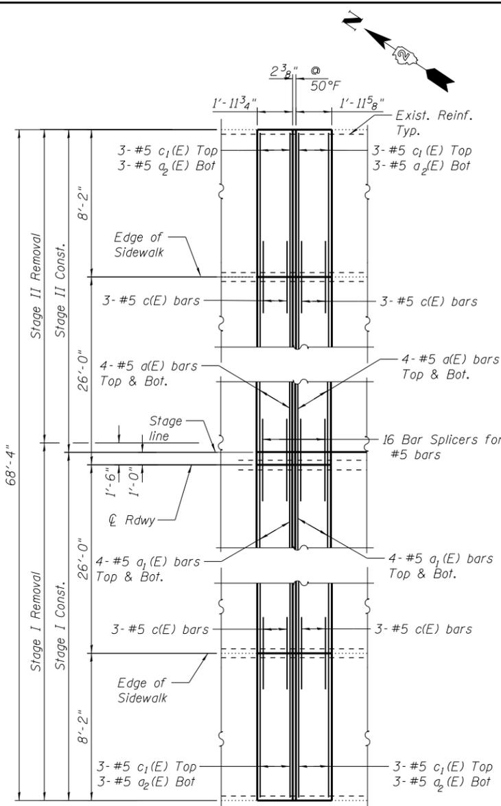
**TRUSS SPAN RELIEF JOINT PLAN**
