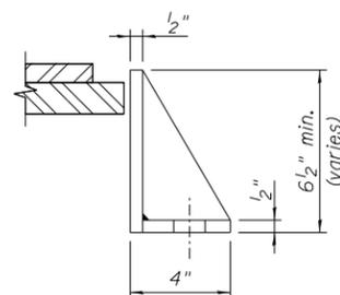
**ELEVATION - SIDE RETAINER**
