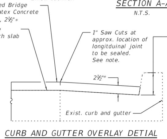
**CURB AND GUTTER OVERLAY DETAIL**
