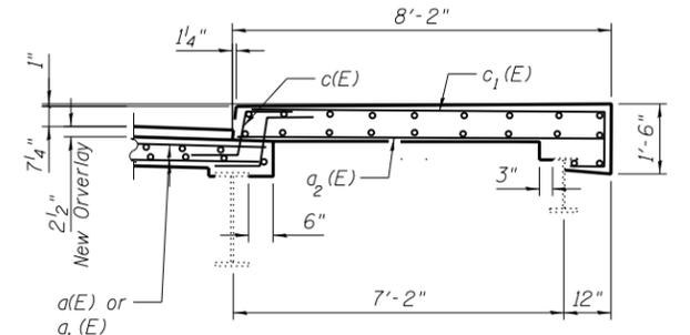
**TYPICAL TRUSS RELIEF JOINT AND ABUTMENT SECTION AT SIDEWALK**
