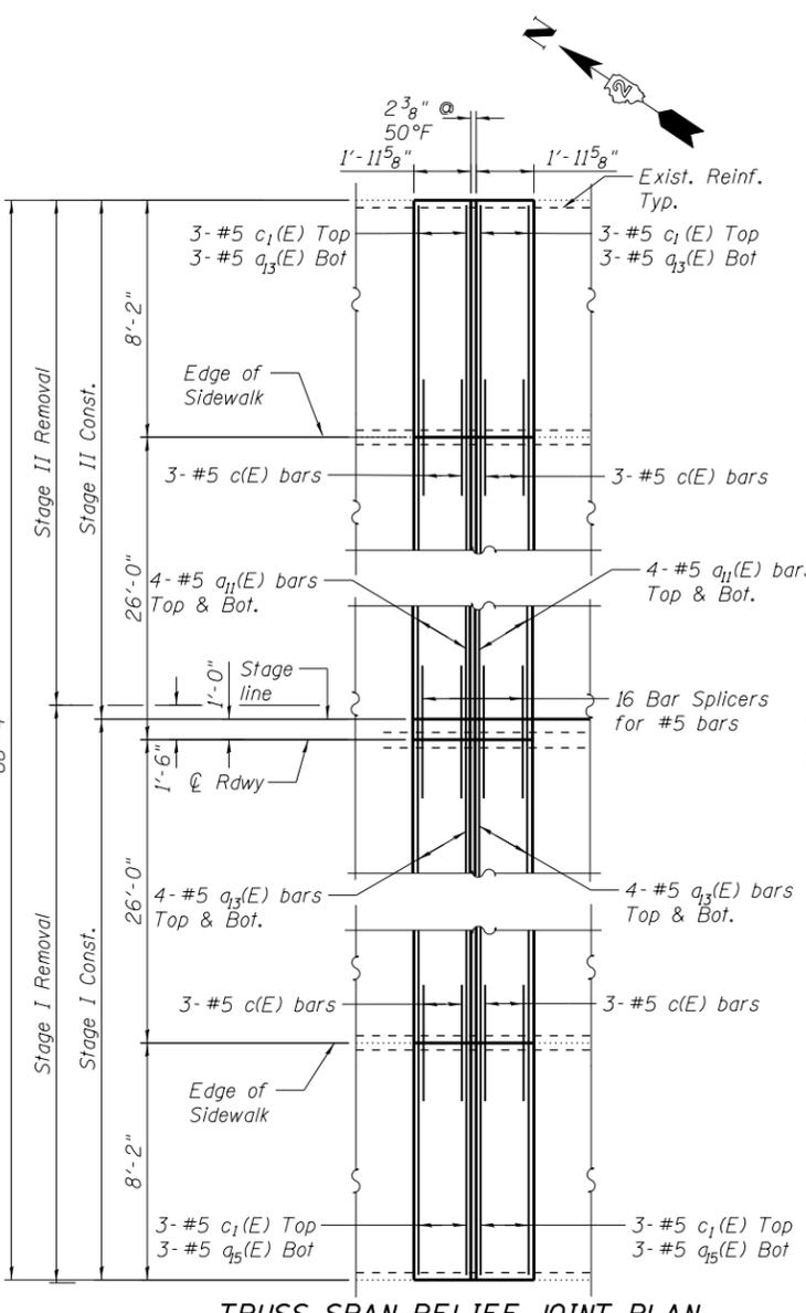
**TRUSS SPAN RELIEF JOINT PLAN**
