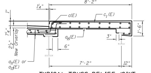
**TYPICAL TRUSS RELIEF JOINT SECTION AT SIDEWALK**
