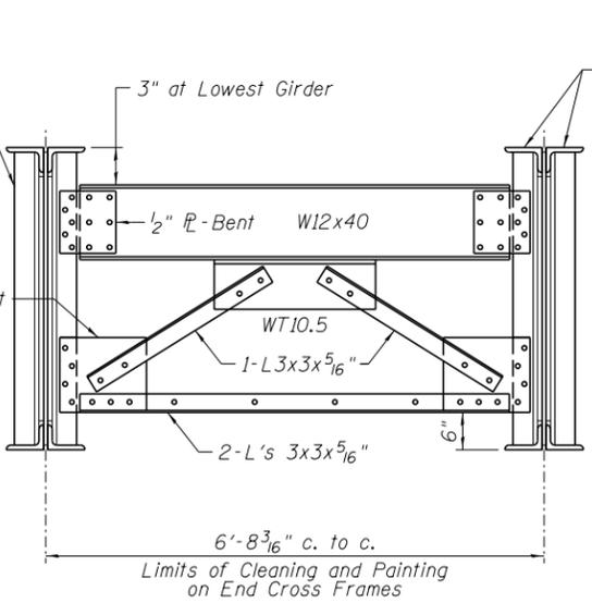
**ELEVATION - END CROSS FRAME F1**
