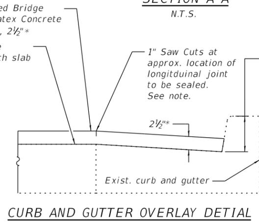
**CURB AND GUTTER OVERLAY DETAIL**
