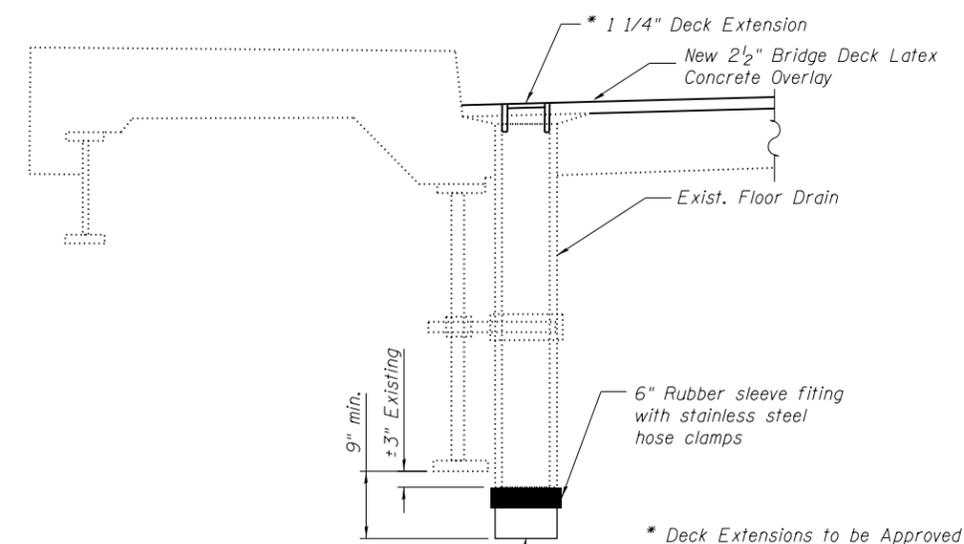
**EXISTING DRAINAGE PIPE TYPICAL**
