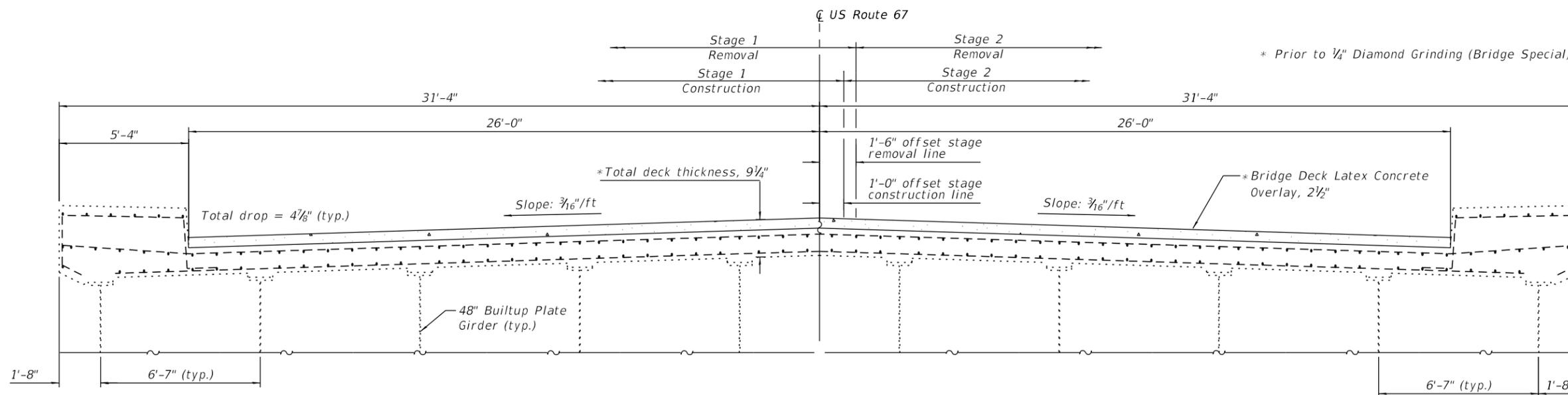
**CROSS SECTION SHOWING NEW OVERLAY**
