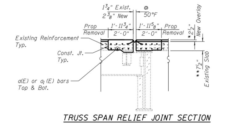
**TRUSS SPAN RELIEF JOINT SECTION**
