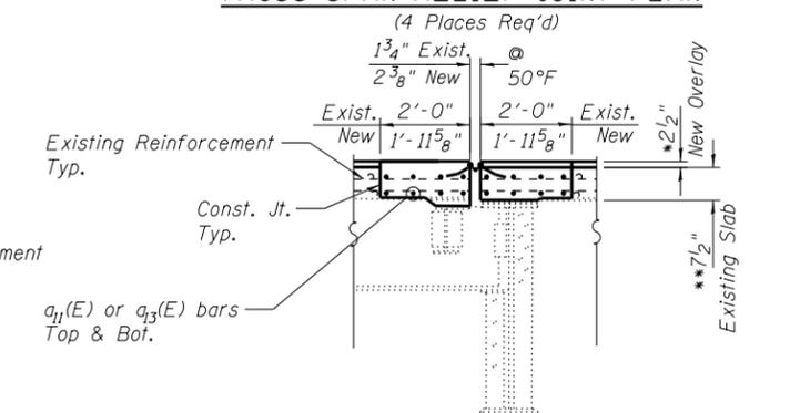
**TRUSS SPAN RELIEF JOINT SECTION**
