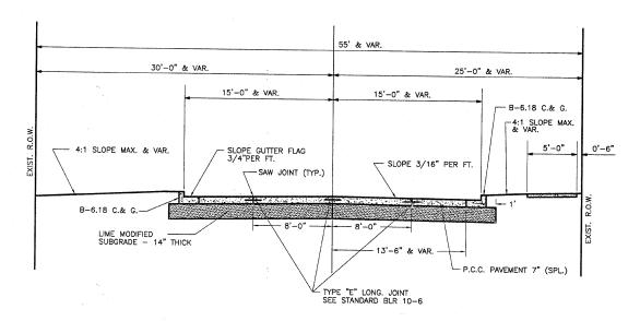
TRANSVERSE CONTRACTION JOINT SPACING SHALL BE AT 12.5 FEET
