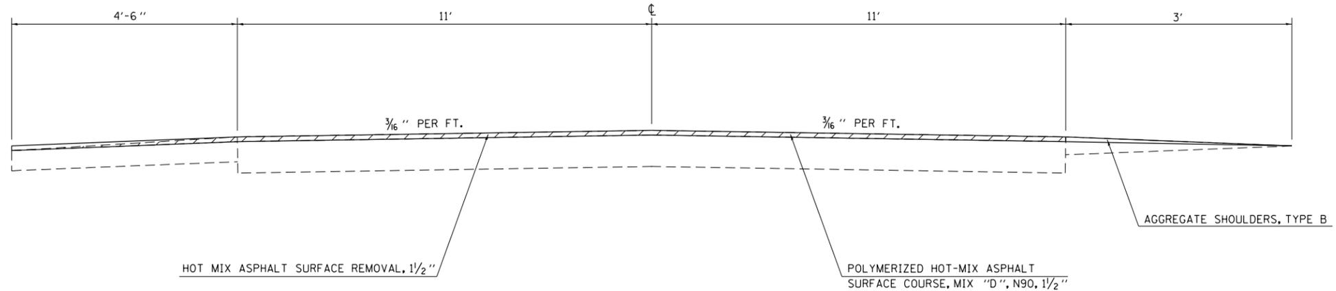
HOT MIX ASPHALT SURFACE REMOVAL, 1/2"
