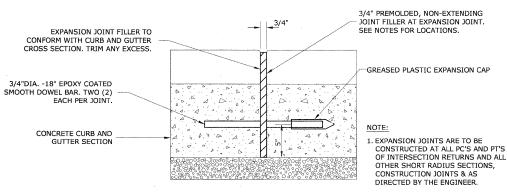
TYPICAL CURB AND GUTTER **EXPANSION JOINT**
