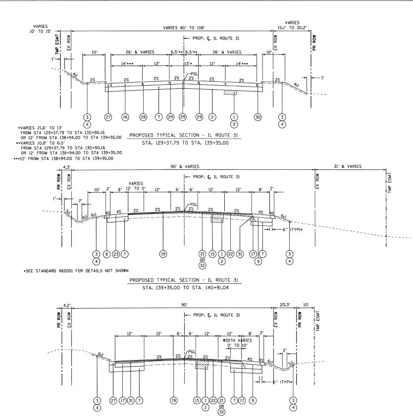
PROPOSED TYPICAL SECTION - IL ROUTE 31 STA. 140+91.04 TO STA. 144+24.00
