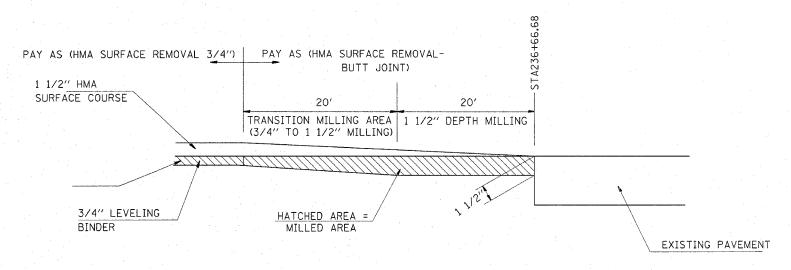
HMA SURFACE REMOVAL - BUTT JOINT (STA. 236+26.68 TO STA. 236+66.68)
