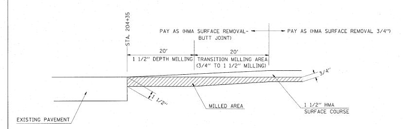
HMA SURFACE REMOVAL - BUTT JOINT (STA. 204+35 TO STA. 204+75)
