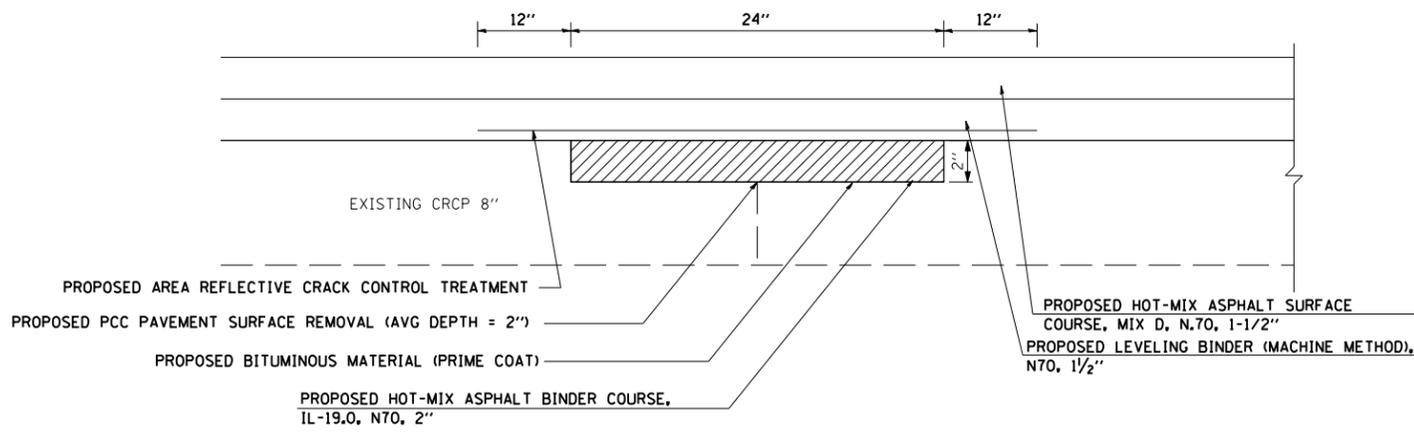
**PROPOSED LONGITUDINAL JOINT REPAIR DETAIL
