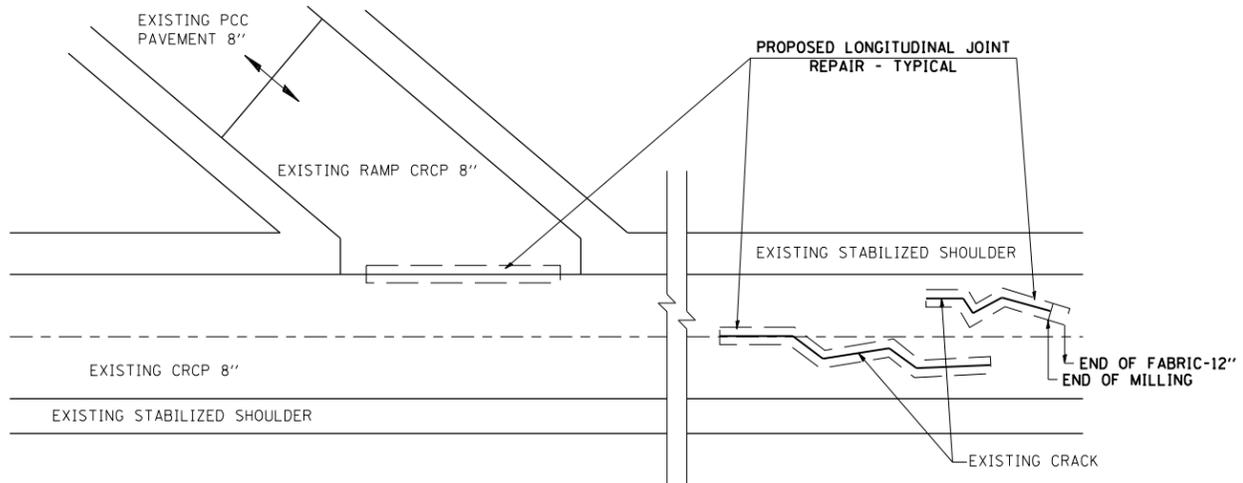
**LONGITUDINAL JOINT REPAIR
