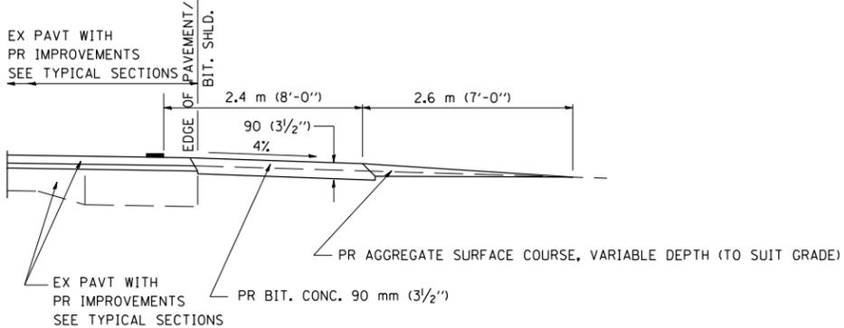
**SECTION A-A FOR EX EARTH/AGGREGATE PE**
