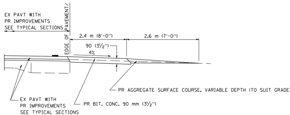
**SECTION A-A FOR EX EARTH/AGGREGATE PE**
