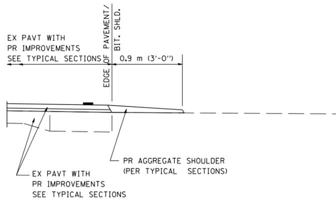
**SECTION A-A FOR EX EARTH/AGGREGATE FE**
