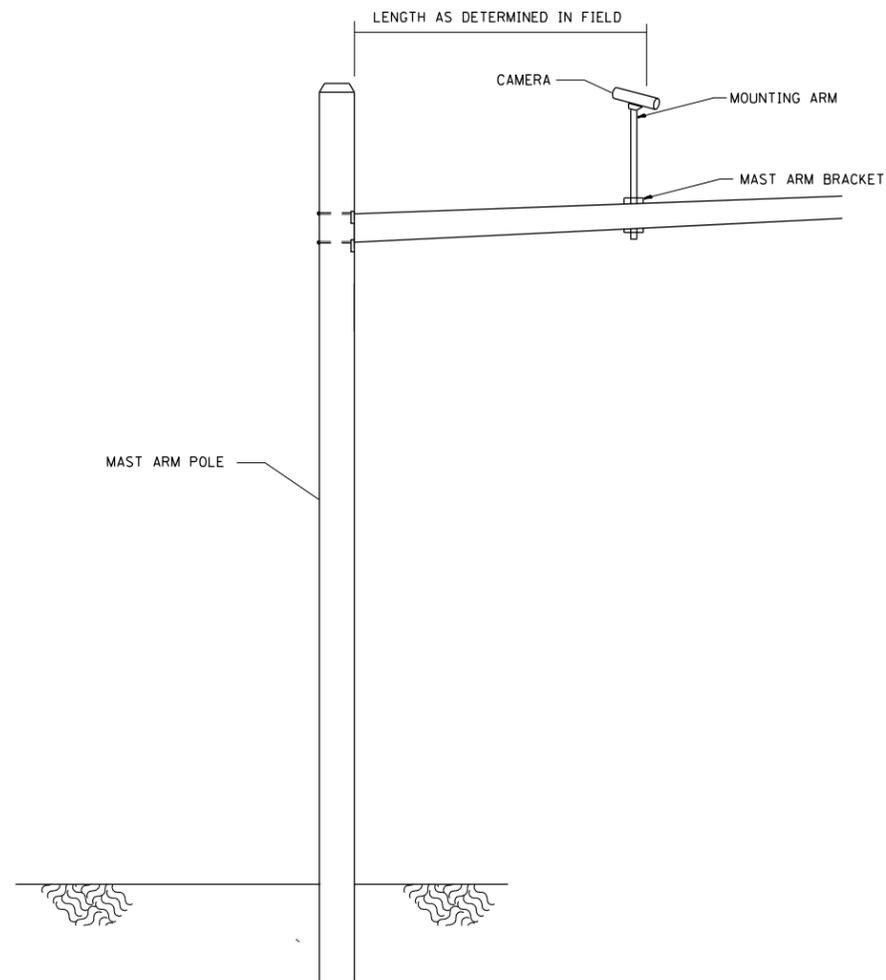
VIDEO DETECTION SYSTEM INSTALLATION
