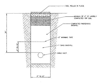
TRENCH & BACKFILL -SOIL AREA IF TRENCH IS USED N.T.S.
