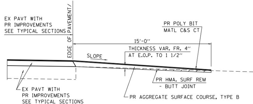
**SECTION A-A FOR EX BIT SIDE RD**
