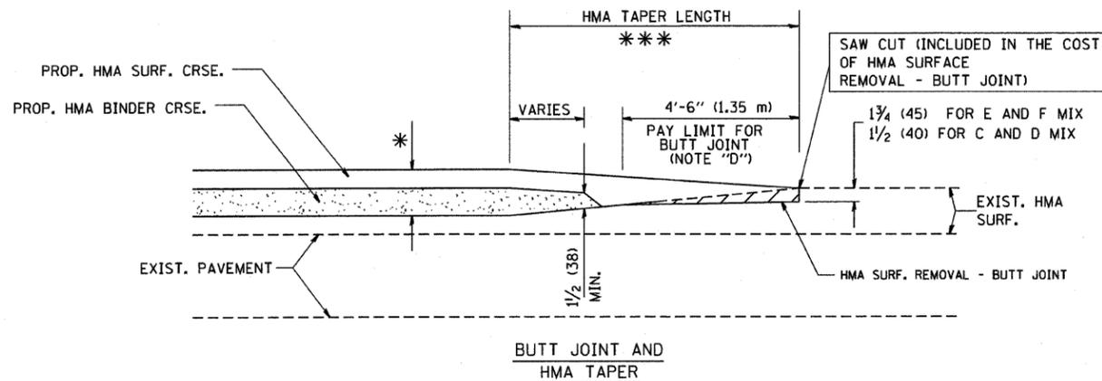
**TYPICAL BUTT JOINT AND HMA TAPER**
