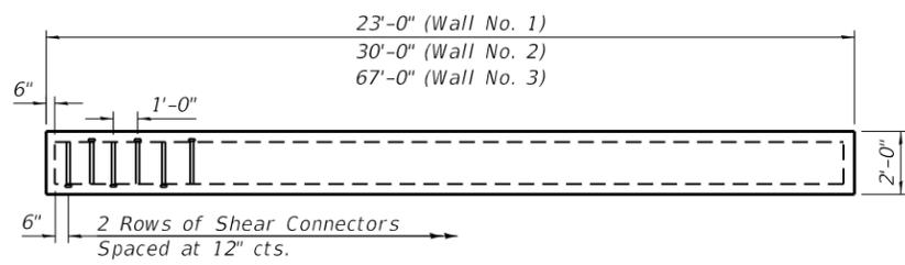
**PLAN VIEW SHEAR STUDS**
