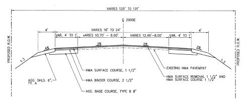
2900E TYPICAL CROSS-SECTION STA 22+91,93 TO STA 25+01,56
