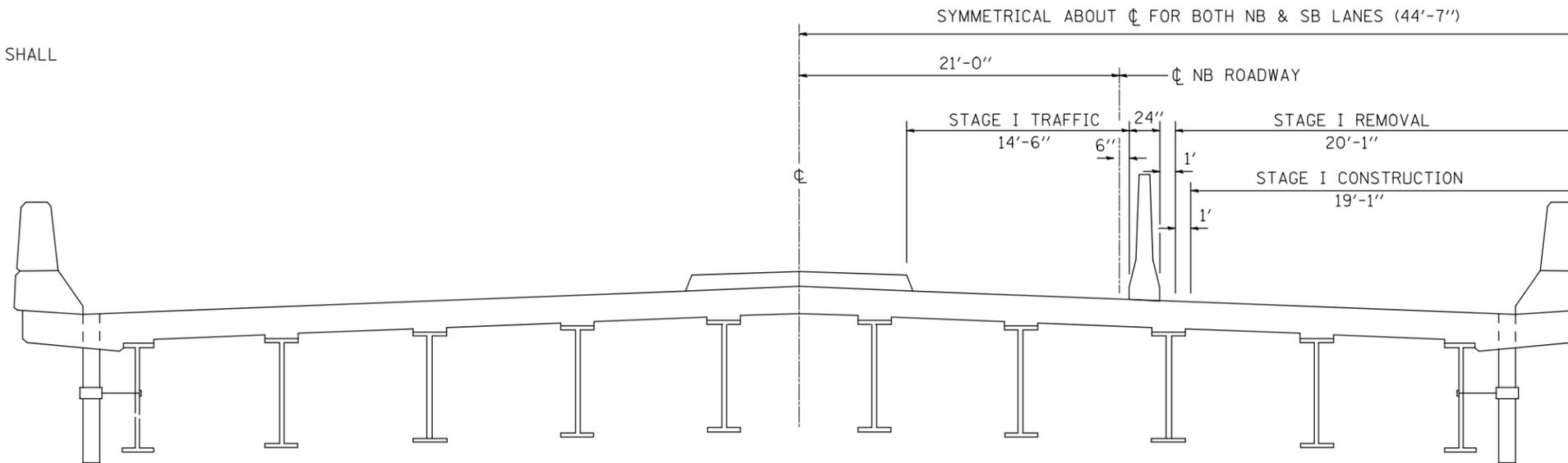
DETAIL NOTE(S): STAGING DETAILS SHOWN HEREIN ARE INTENDED TO BE USED IN ACCORDANCE WITH HIGHWAY STANDARD 701422-02 & 701423-03
