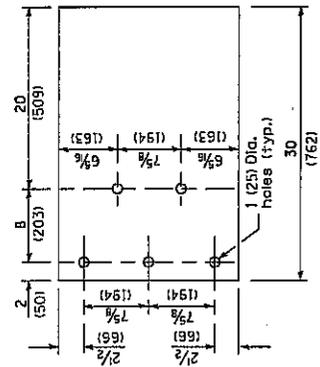
PARAPET WOOD BLOCK-OUT DETAIL
