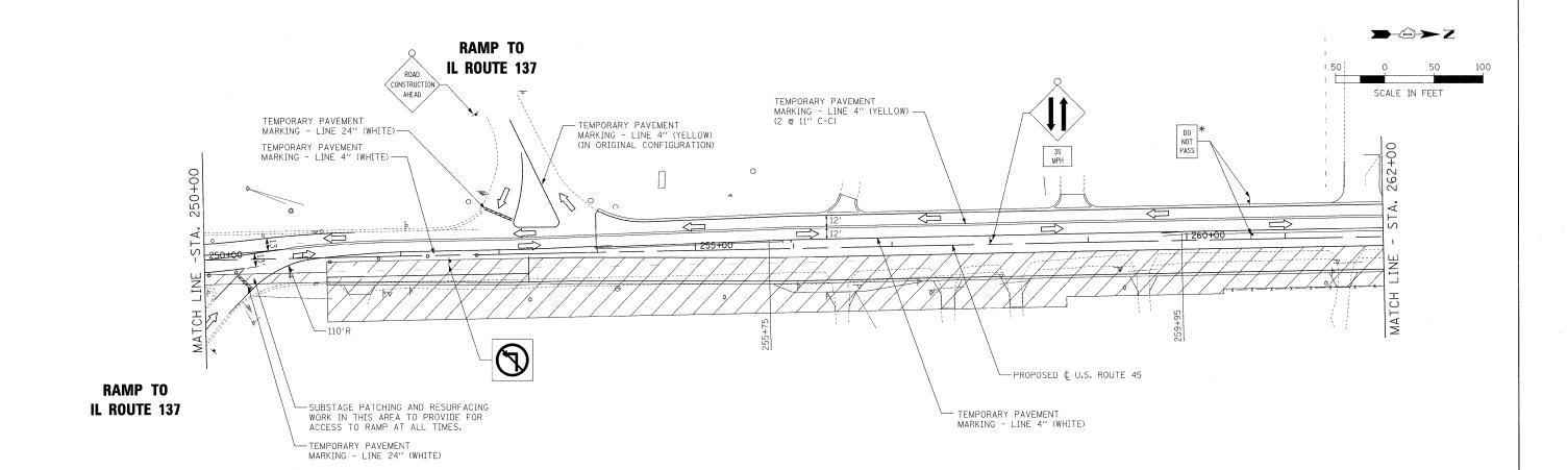
CROSSOVER TO BE INSTALLED USING LANE MARKING, TRAFFIC CONTROL AND ADVANCE SIGNING PER IDOT STD 701606.
