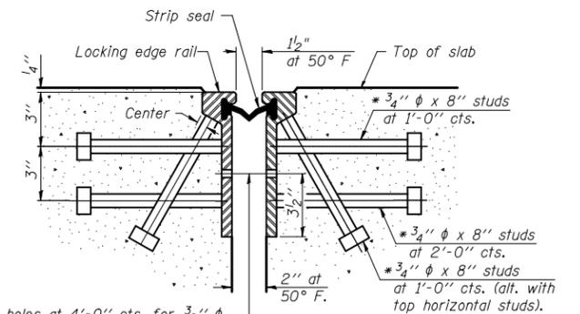
PREFORMED JOINT STRIP SEAL DETAIL
