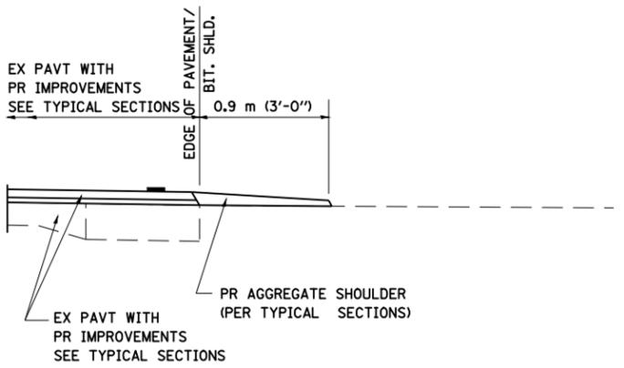
**SECTION A-A FOR EX EARTH / AGGREGATE FE**
