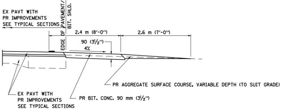
**SECTION A-A FOR EX EARTH / AGGREGATE PE**
