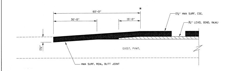
HMA TAPER AT BUTT JOINTS
