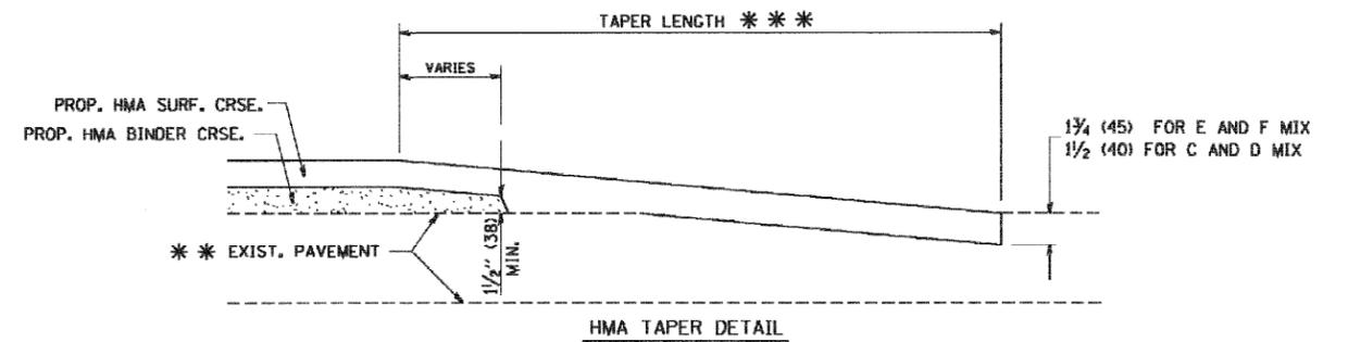
**TYPICAL BUTT JOINT AND HMA TAPER
