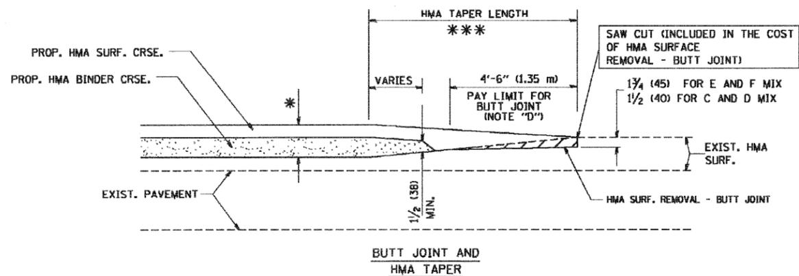
**TYPICAL BUTT JOINT AND HMA TAPER
