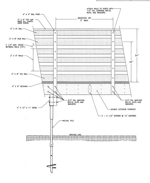
SIDE ELEVATION - WOOD DECKING SPECIAL
