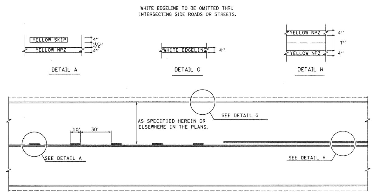
TYPICAL CENTERLINE, NO PASSING ZONE LINE (NPZ) & EDGELINE MARKINGS
