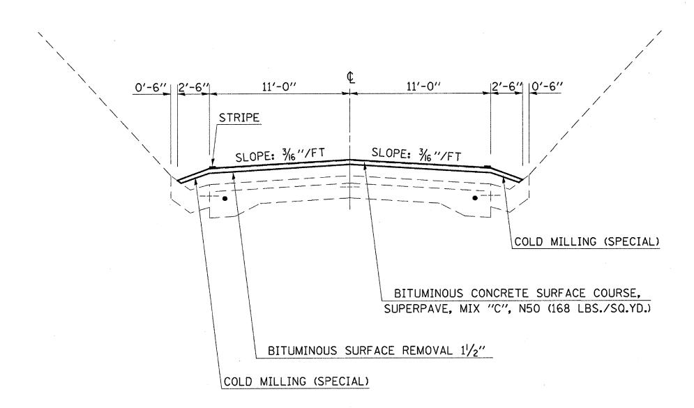
NOTE: THE TRANSITION FORM BITUMINOUS SURFACE REMOVAL 11/4" TO BITUMINOUS SURFACE REMOVAL 11/2" WILL BE PAID FOR AS BITUMINOUS SURFACE REMOVAL 11/4".
