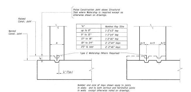
CONSTRUCTION JOINTS KEY DETAILS
