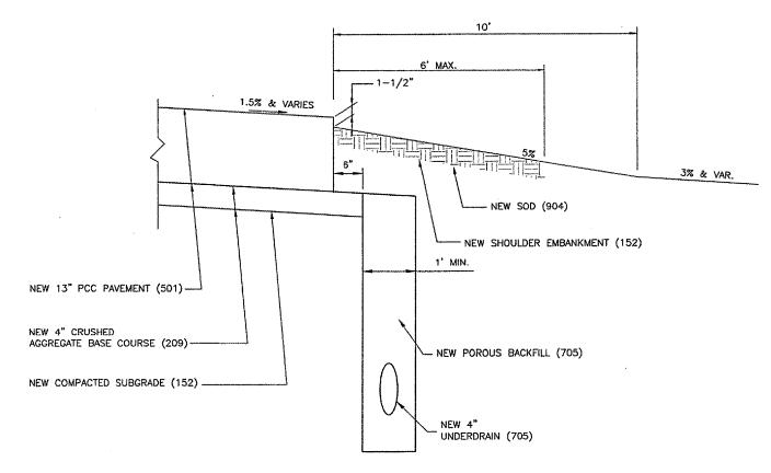
**NEW TURF SHOULDER** TYPICAL SECTION N.T.S.
