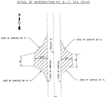
NOTE: THE QUANTITY SHOWN FOR BITUMINOUS CONCRETE SURFACE COURSE, SUPERPAVE, MIX "C". N50 INCLUDES 9.4 TONS OF MATERIAL FOR THE SIDEROAD LT APPROACH AND RADII AND 13.8 TONS OF MATERIAL FOR THE SIDEROAD RT. APPROACH AND RADII.
