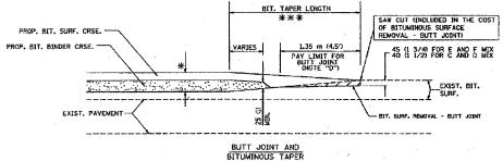
TYPICAL BUTT JOINT AND BITUMINOUS TAPER
