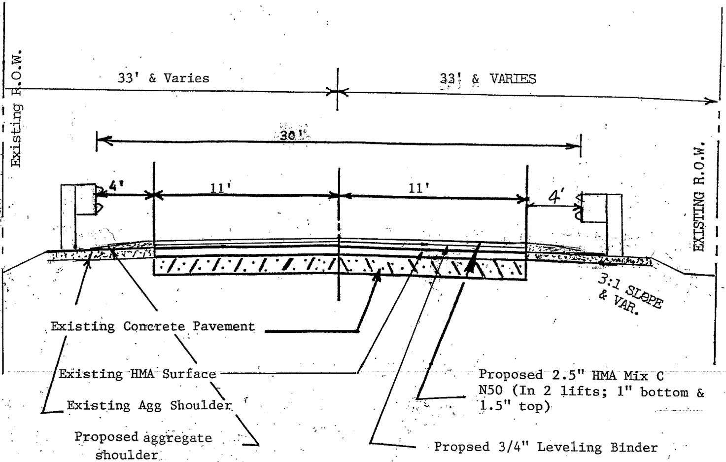
TYPICAL SECTION WITH GUARDRAIL
