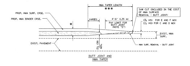
TYPICAL BUTT JOINT AND HMA TAPER
