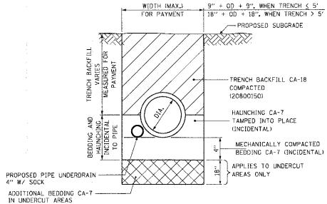
TO BE PAID FOR AS TRENCH BACKFILL
