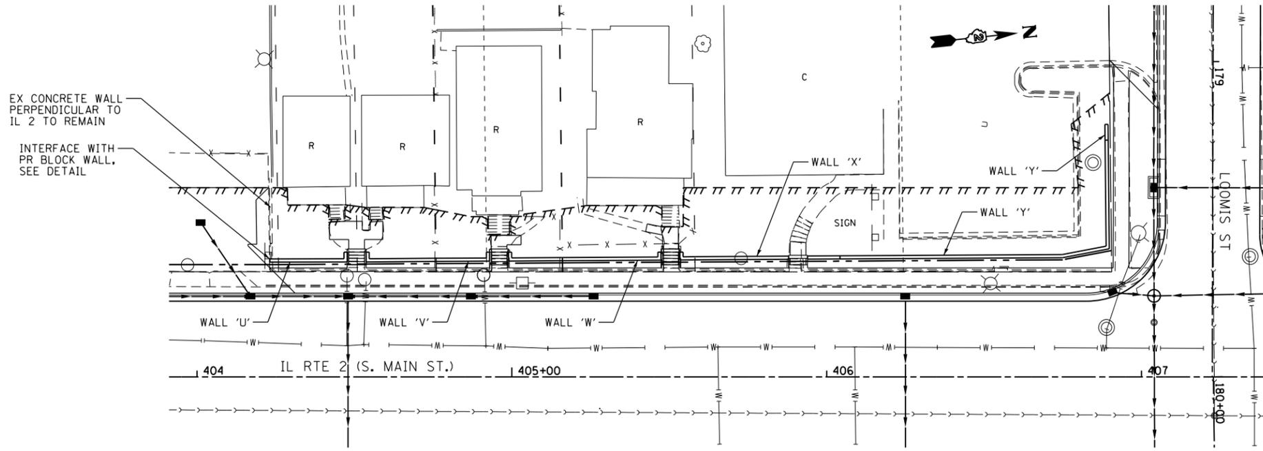
**SEGMENTAL CONCRETE BLOCK WALL PLAN**
