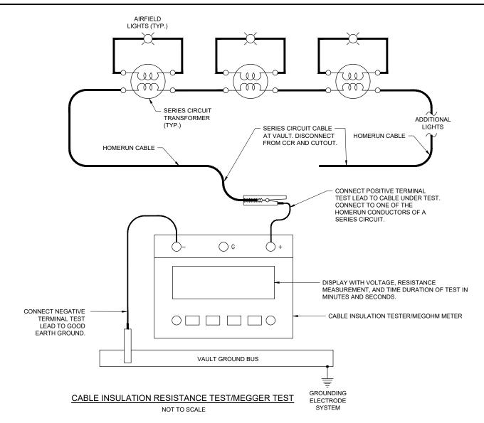
CABLE INSULATION RESISTANCE TEST (MEGGER TEST) NOTES
