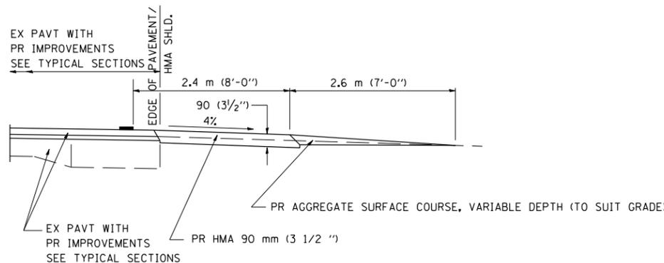
**SECTION A-A FOR EX EARTH/AGGREGATE PE**
