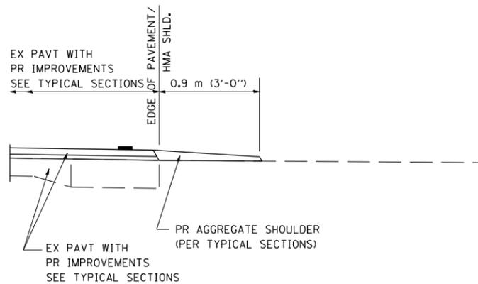
**SECTION A-A FOR EX EARTH/AGGREGATE FE**
