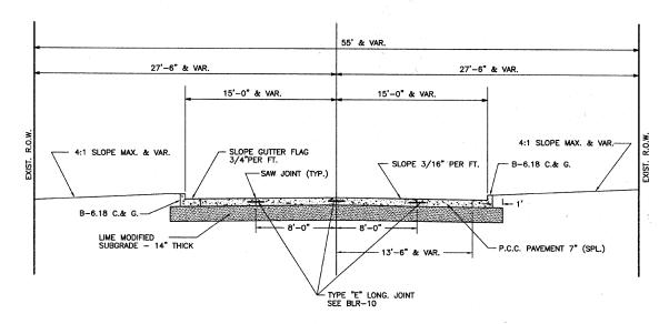
TRANSVERSE JOINT SPACING SHALL BE AT 12.5 FEET
