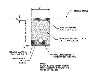
PIPE UNDERDRAINS, FABRIC LINED TRENCH, 4"
