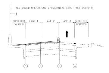
STAGE III - OPERATION THREE - I-290 BITUMINOUS SURFACE REMOVAL FINAL 2" - LANES 1 & 2 BITUMINOUS SURFACE REMOVAL FINAL,  $1-\frac{3}{a}$ " - SHOULDER & OUTSIDE OF ROOSEVELT ROAD RAMPS TO 1-88
