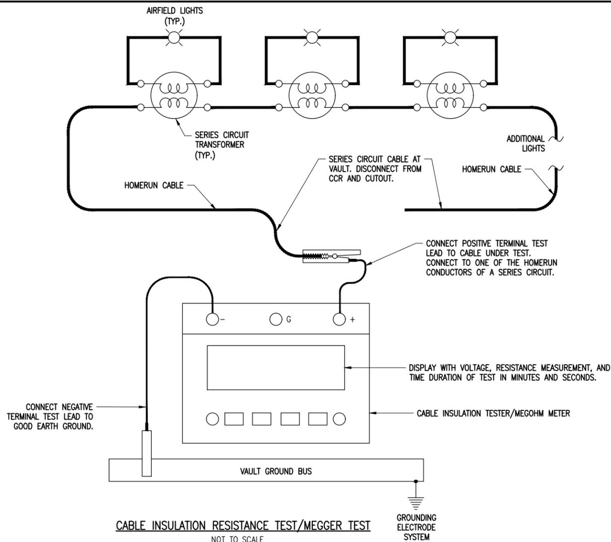
**CABLE INSULATION RESISTANCE TEST (MEGGER TEST) NOTES**
