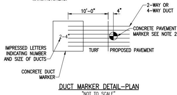
DUCT MARKER DETAIL-PLAN
